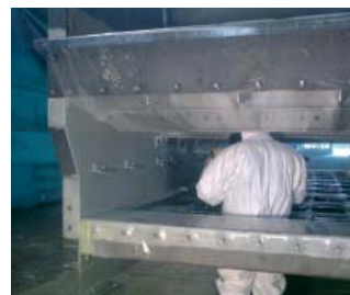
Подкладка Для защиты внутренней поверхности грохота от коррозии, используются специальные пластиковые покрытия или краска
