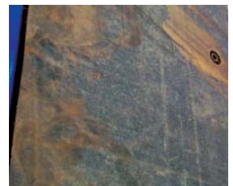
Подкладка Для защиты внутренней поверхности грохота от истирания, используется закаленная сталь с резиновыми вкладышами.
