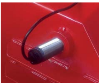
Датчик скорости/вращения Для подтверждения правильности работы задающего резонатора.
